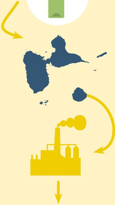
Le verre reste en Guadeloupe où il est transformé en verre (en sable) et est utilisé pour les sous-couches routières.
